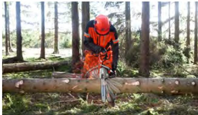
Cette méthode est adaptée aux arbres dont les branches sont de taille petite à moyenne et bien circulaires. Par exemple, si une grosse branche suspendue est susceptible de coincer la chaîne et le guide-chaîne, il peut être nécessaire d'adopter une autre méthode.
